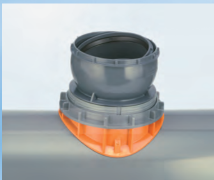
CONNEX-kobling DN/OD 160/200 til CONNEX-avløpsrør, Boring 200 ± 1 mm
